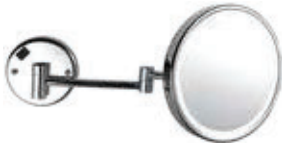
WHJ2006A 表面处理：镀铬 产品名称：化妆镜 主体材质：铜 功能特点：3 倍放大镜 光源：LED (发光二极管) 输入电压：AC220V 接线端口：3 pin
